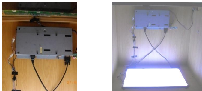
Fig. 2.8. Proyector, tarjeta lógica y matriz LCD conectados.
