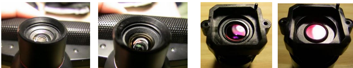
Fig. 2.5 Detalle de los lentes y los filtros de los dos modelos de PS3Eye. Izquierda modelo incorrecto, derecha modelo indicado. Imágenes tomadas del blog de Chris Nolan; http://www.peauproductions.com/blog/page/3/?s=ps3
