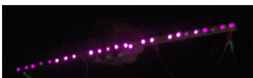
Fig. 2.11.Detalle del arreglo de LEDs que se integra a la interfaz.
