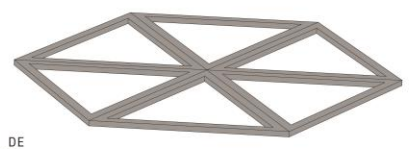
PLACA EN ESTRUCTURA METALICA ALIGERADA.
