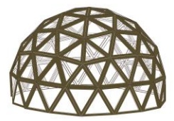
TRIANGULOS EN MADERA TIPO TECA POR ENCIMA DE ESTRUCTURA METALICA.
