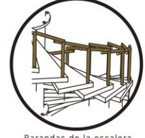
Barandas de la escalera hacen pieza unica con los peldaños.
