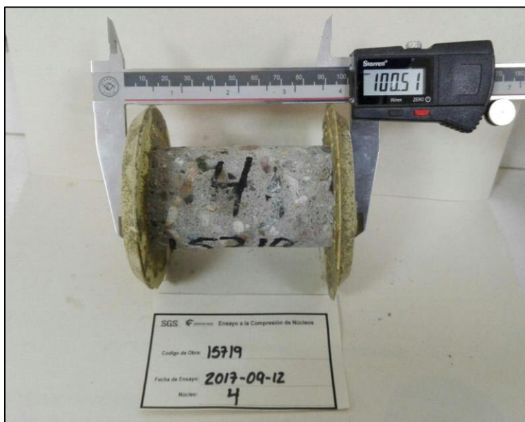
Fig. 22. Núcleo refrentado y con acondicionamiento de humedad listo para ensayo
