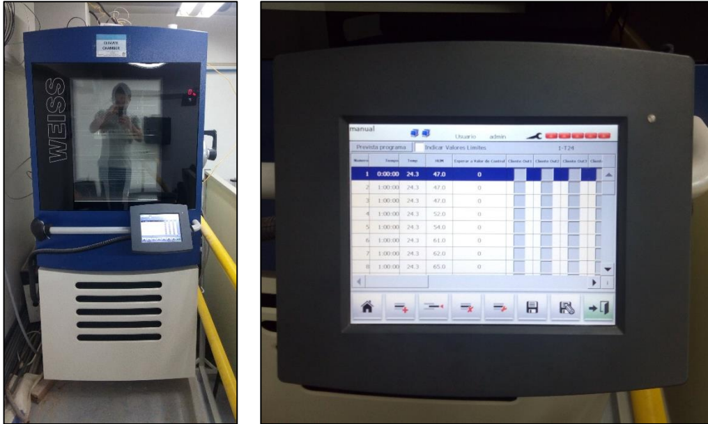
Fig. 12. Cámara climática para el curado con acondicionamiento de temperatura
