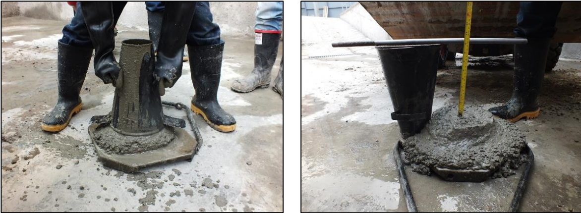
Fig. 5. Ensayo para determinar el asentamiento del concreto según ASTM C143-90
