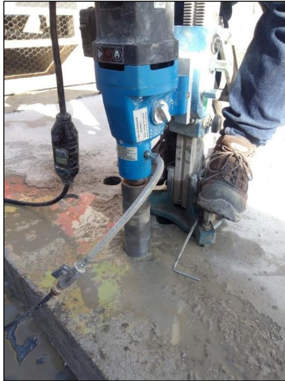
Fig. 10. Sistema de perforación para concreto con columna DD 150-U
