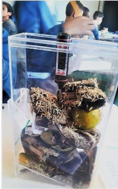
Figura 6. Fotografía Sección Secundaria del prototipo de dispositivo didáctico experimental. Se observa material orgánico en descomposición y la medición de la temperatura con termómetro de punzón.
