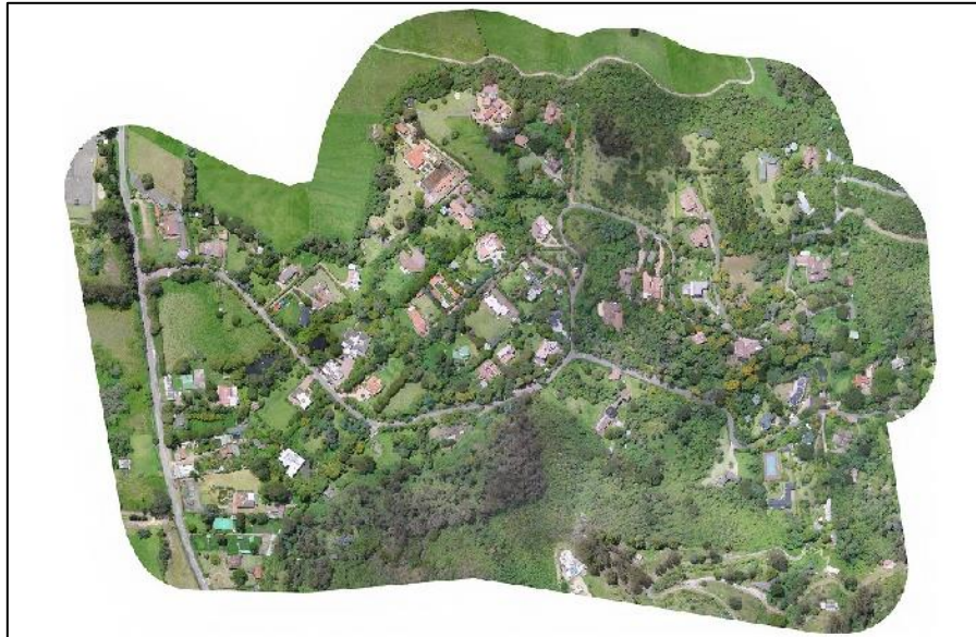
Imagen 9. Ortofotomosaico obtenido a partir de la incorporación de las fotografías aéreas y puntos de control en el Software Pix4D.
