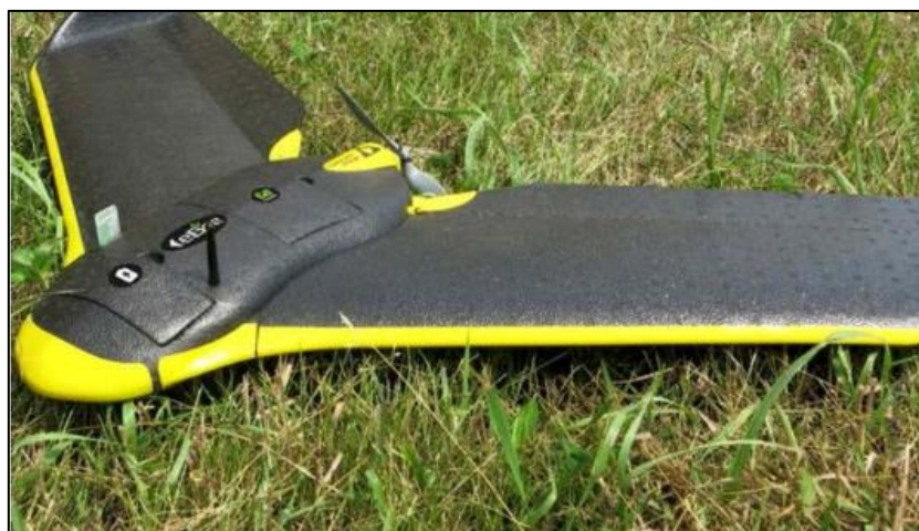
Imagen 6. Equipo UAV para la adquisición de datos, específicamente fotografías aéreas.
