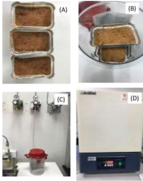
Figura 4.2. Sistema para producción de BC (A). Aserrín de pino seco y tamizado (B). Cámara de Anaerogen® con el aserrín y el catalizador. (C). Sistema para el suministro de Nitrógeno. (D) Mufla LabTech® empelada como termoreactor (Fuente: Chacón., (2019), Blanco., (2020))
