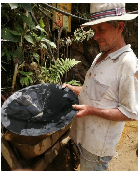
Figura 9. Extracción de oro utilizando batea. Fuente: esta investigación.
