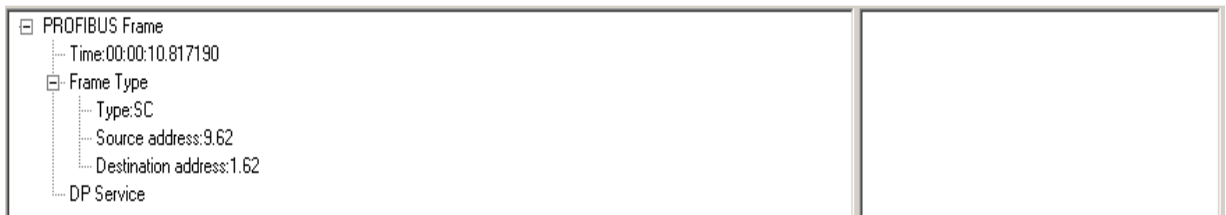
Figura 58. Tramas de Configuración y Respuesta visto en el Analizador de Protocolo
