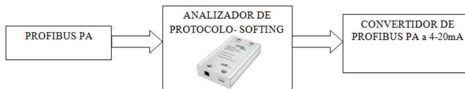
Figura 29. Proceso de verificación de trama PROFIBUS PA
