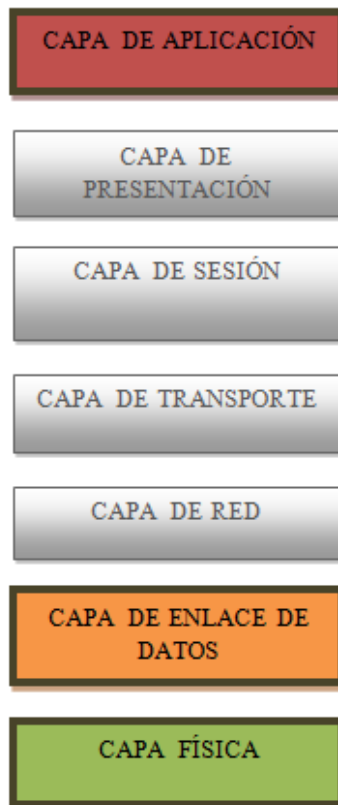
Figura 4. Arquitectura del modelo OSI
