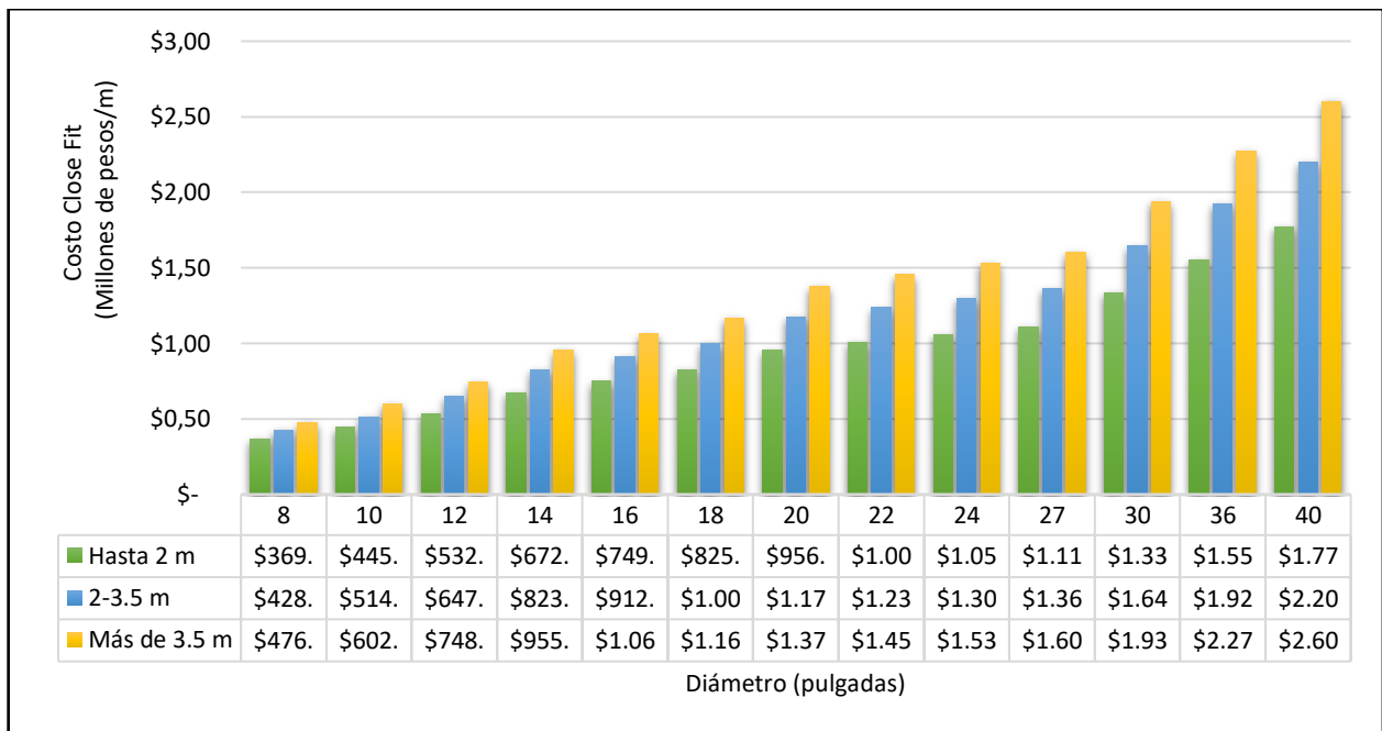
(b) Costo Close Fit por metro lineal vs diámetro – Fuente: Elaboración propia modificado de fuentes de información
