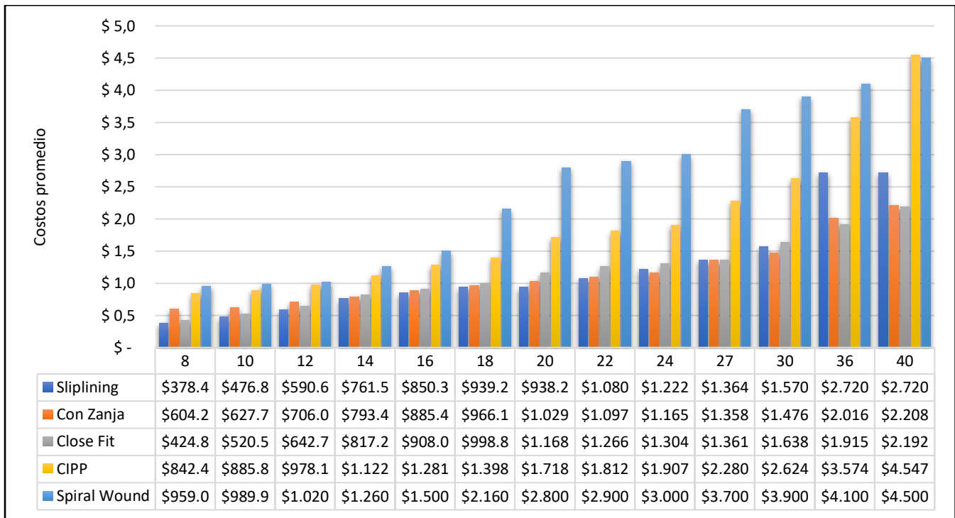
Figura 4. Costos promedio por diámetro de las técnicas de rehabilitación. Fuente: elaboración propia modificado de fuentes de información
