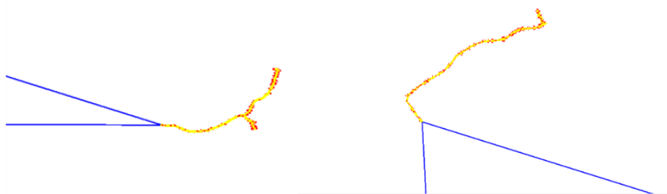
Figura 3-26: En esta figura se puede ver la trayectoria que recorren los dos electrones generados mediante interacción por el fotón de la figura anterior con 150 keV de energía inicial.
