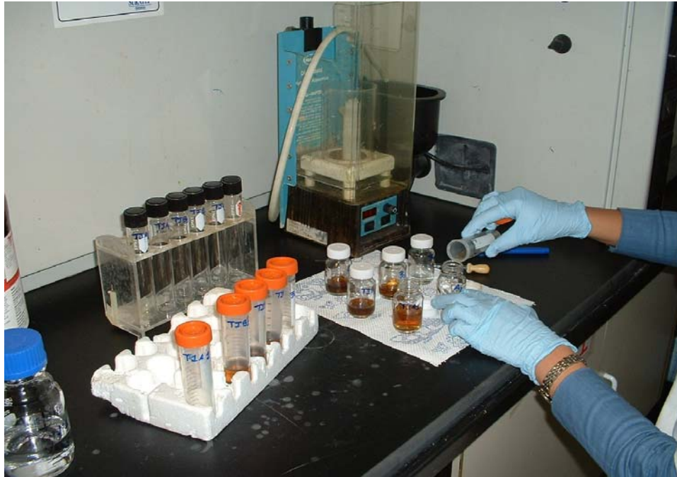
Figura 6. Proceso de extracción de TPHs del suelo contaminado, por el método de EAMG (Schawab et al. , 1999; EPA, 1994)
