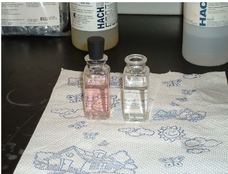
Figura 8. Determinación de nitrato en muestras de suelo empleando el método No 366 ( \lambda=500\text{nm} ) (HACH, 1994).
