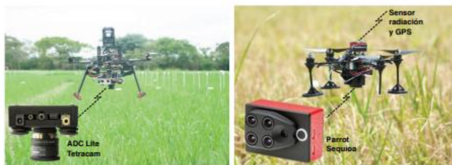
Figura 16. Drones instrumentados e integrados para el Proyecto: Astec Pelican con cámara multispectral ADC Lite de Tetracam y Astec Hummingbird con cámara multispectral Sequoia de Parrot.
