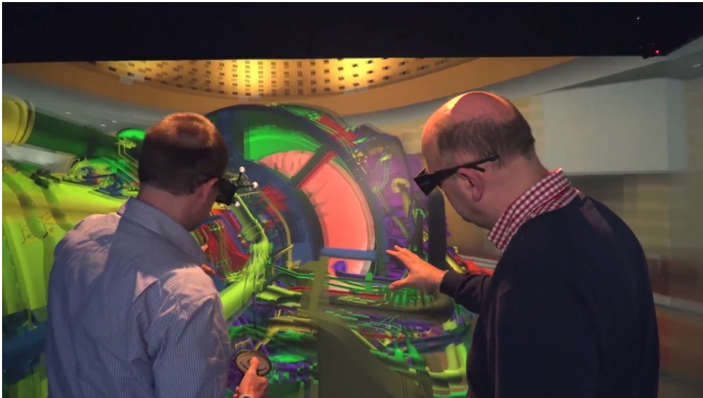
Sistema CAVE con una cámara IR (esquina superior derecha) y dos usuarios utilizando anteojos polarizados con marcadores. Tomado de https://www.youtube.com/watch?v=orbrlW6mBGw .
