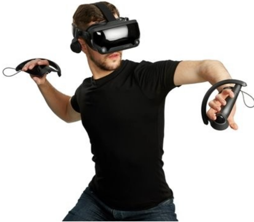
Figura 5: Valve Index con controles de movimiento ergonómicos y cámaras infrarrojas para detección de posición en el espacio. Tomado de https://uploadvr.com/valve-index-hands-on/ .
