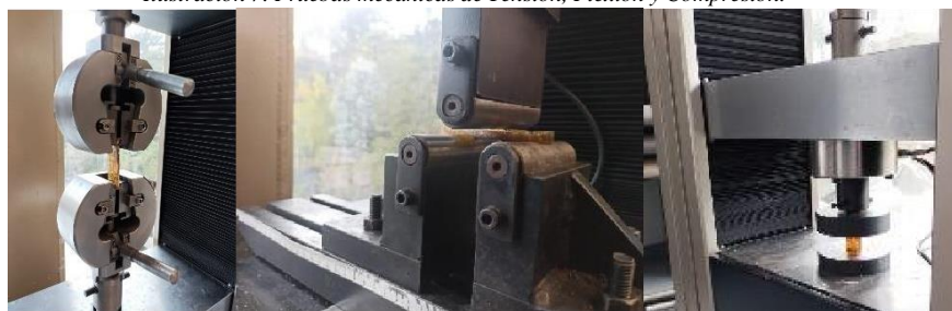
Ilustración 7. Pruebas mecánicas de Tensión, Flexión y Compresión.
