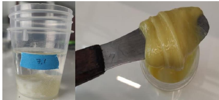
Ilustración 4. Disolución de EPS con biosolvente.
