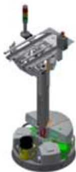
Ilustración 3. Mobil robot Robotino for boxes. Fuente: (Festo Didactic, 2019a)
