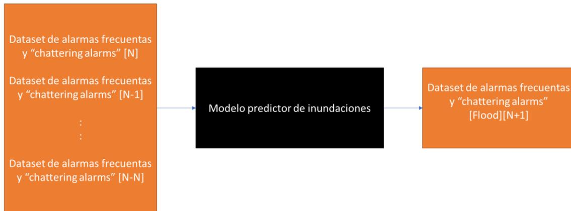
Imagen 10: Diagrama en bloques de modelo predictor de inundaciones
