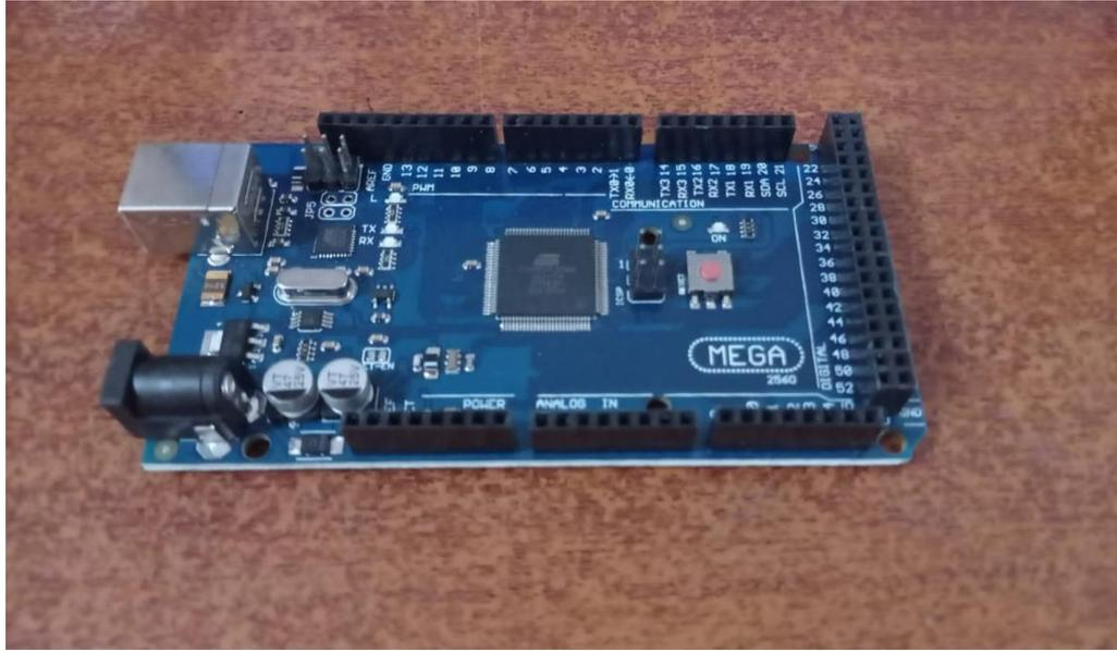
*Ilustración 24* Elemento principal de la parte electrónica, Arduino mega 2560, foto de autoría propia
