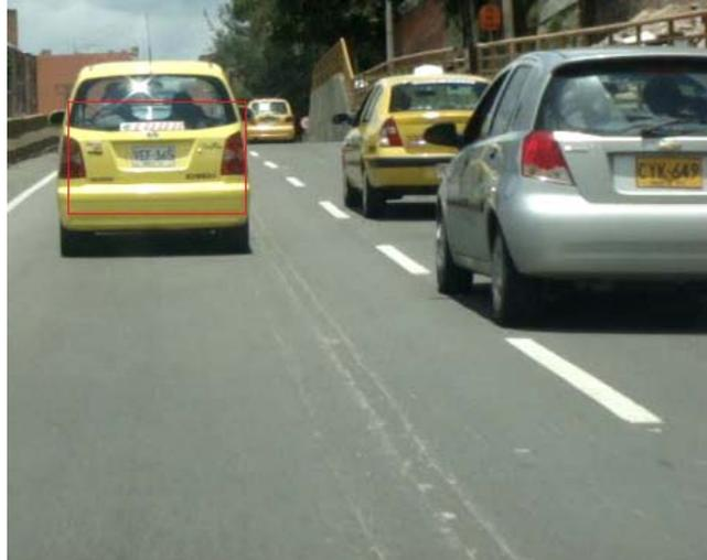
Figura 34. Vista con una cantidad de luz normal y distancia de aprox. 4 metros entre el vehículo que lleva la cámara y la placa, donde se pueden identificar los caracteres de la placa.
