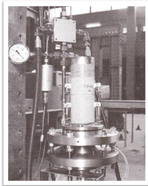
Imagen 4.13. Fotografía de la celda de carga abierta que muestra un espécimen instrumentado [17]
