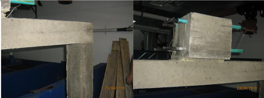
Imagen 5.15. Desencofrado del pórtico
