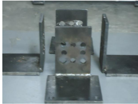
Imagen 5.7. Platinas del sistema de apoyos
