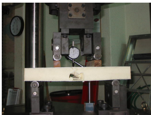
Fotografía 4.1. Detalle vacío en el poliuretano
