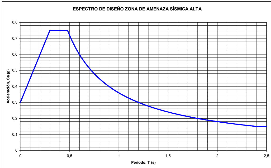
Figura 5.15. Espectro de diseño para zona de amenaza sísmica alta
