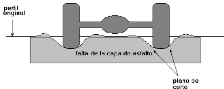
Figura 48: Ahuellamiento por deficiencias en la capa asfáltica Fuente: Antecedentes del diseño y análisis de mezclas asfálticas de Superpave
