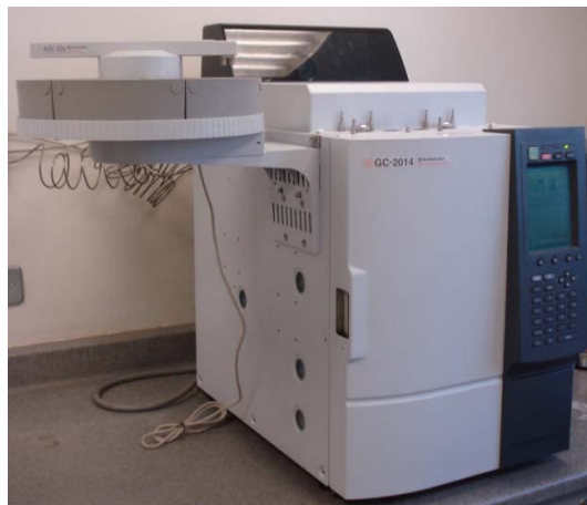
Figura 3. Cromatógrafo Shimadzu GC-2014 empleado en la determinación de la producción de CO 2 en los microcosmos.
