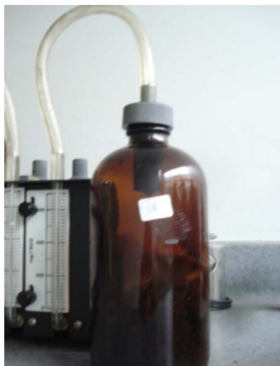
Figura 2. Equipo HACH utilizado para determinar el consumo de \text{O}_2
