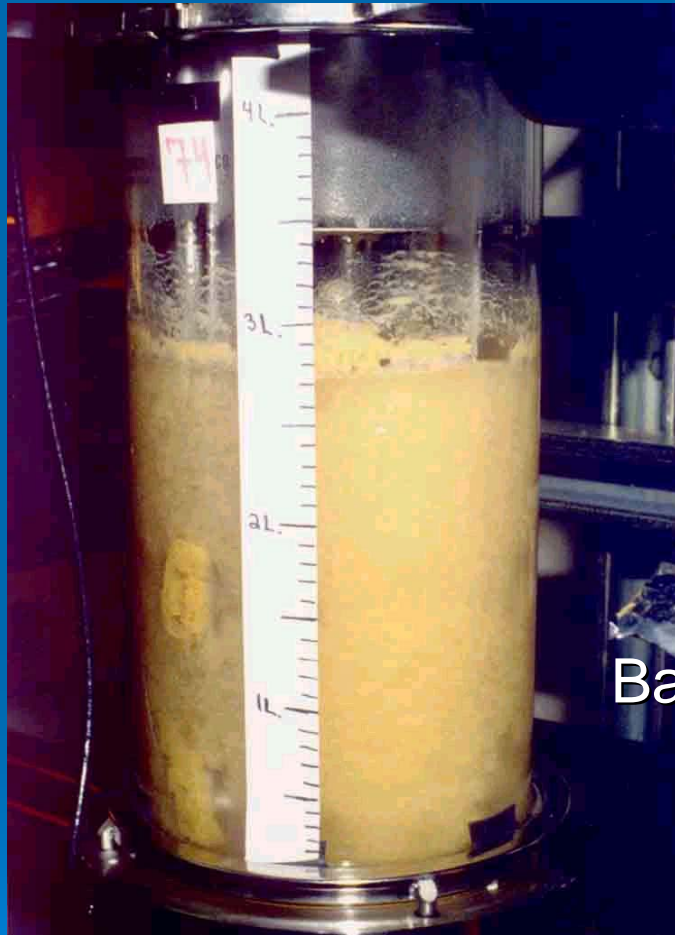
Fermentación de Trichoderma viride para la producción de celulasas a partir de bagazo de caña
