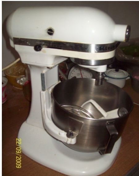
FIGURA 4. Batidora industrial con una capacidad 1 ½ libras de masa
