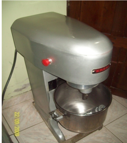
FIGURA 5. Batidora industrial con una capacidad 5 libras de masa
