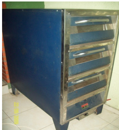
FIGURA 6. Horno industrial con una capacidad para hornear de 9 a 12 moldes según el tamaño (de libra o de media)
