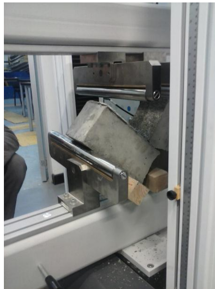
Figura 3.12 Rotura de la Viga de Concreto
