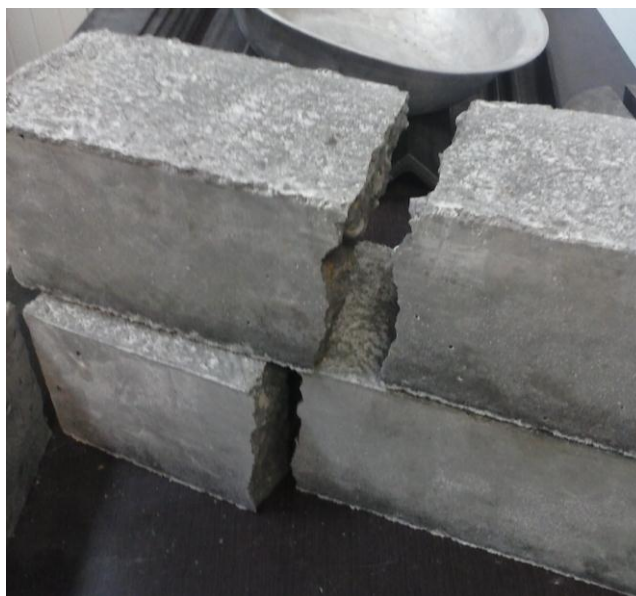
Figura 4.5 Falla Viga por Flexión.
