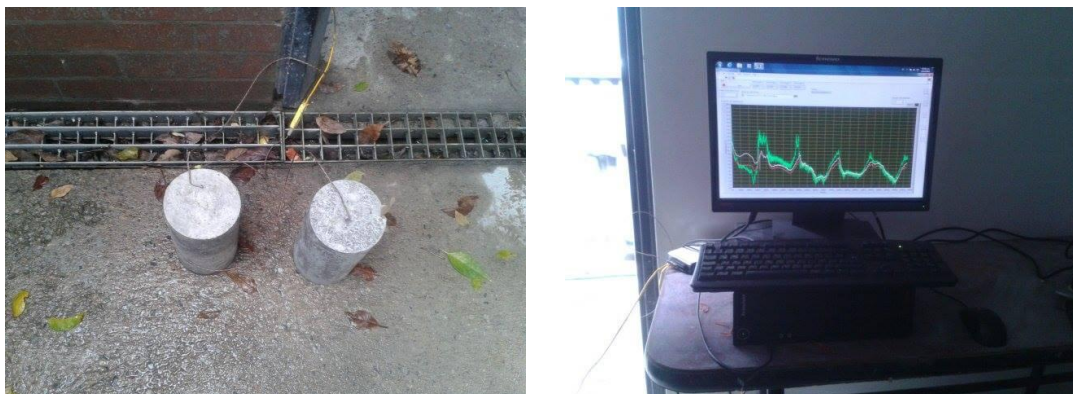
Figura 3.19 Montaje medición de temperatura
