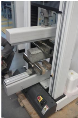
Figura 3.11 Montaje Ensayo de Resistencia a la Flexión en Vigas de Concreto
