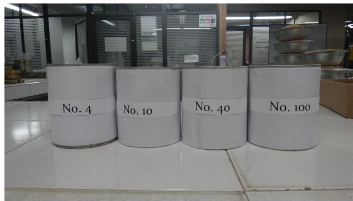
Fotografía 16. Separación de la muestra de Roca degradada en las fracciones seleccionadas como representativas
