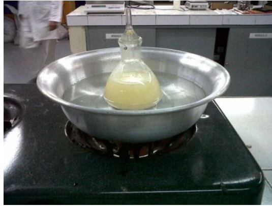
Fotografía 15. Picnómetro utilizado en el ensayo de gravedad específica
