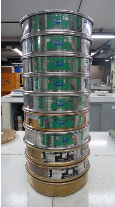
Fotografía 12. Serie de tamices para ensayo de granulometría
