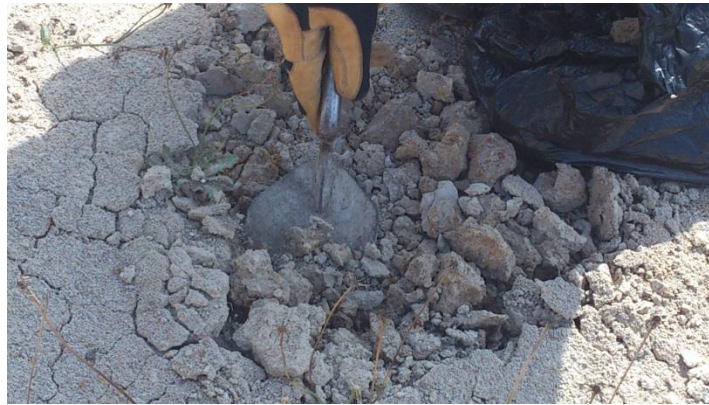
Fotografía 10. Obtención de muestras con palustre
