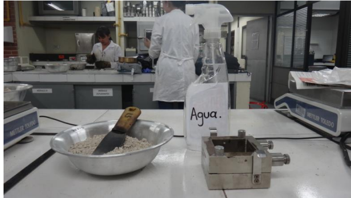
Fotografía 21. Muestra de material, agua y cámara de corte
