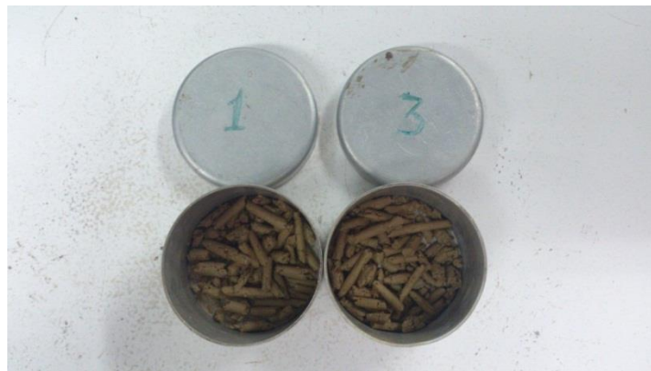
Fotografía 14. Rollitos para la determinación del límite plástico
