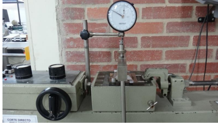
Fotografía 26. Prueba de consolidación en el equipo de corte
