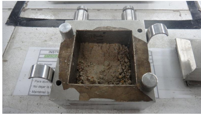
Fotografía 22. Armado de la primera capa de material
