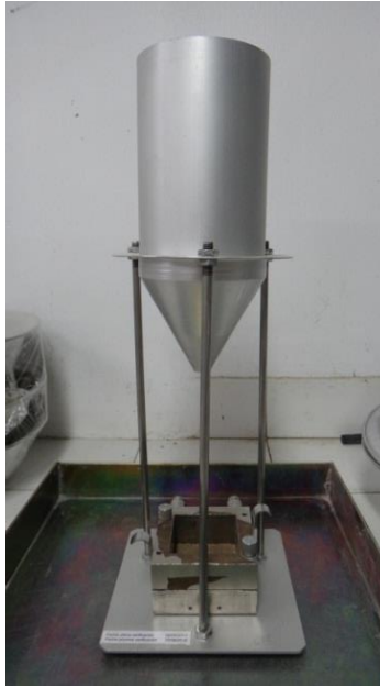
Fotografía 18. Embudo utilizado en la Pluviación para la conformación de la densidad suelta
