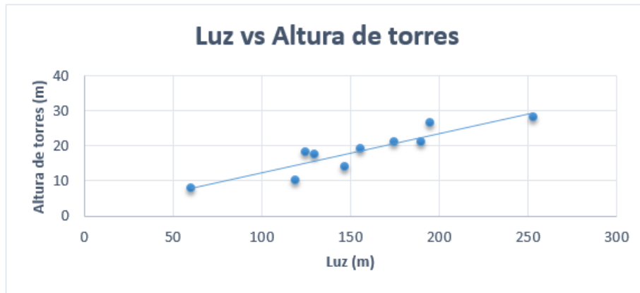
Gráfica 5.2 Tendencia en construcción de pasos aéreos en Colombia (Luz vs Altura torre). Fuente propia
