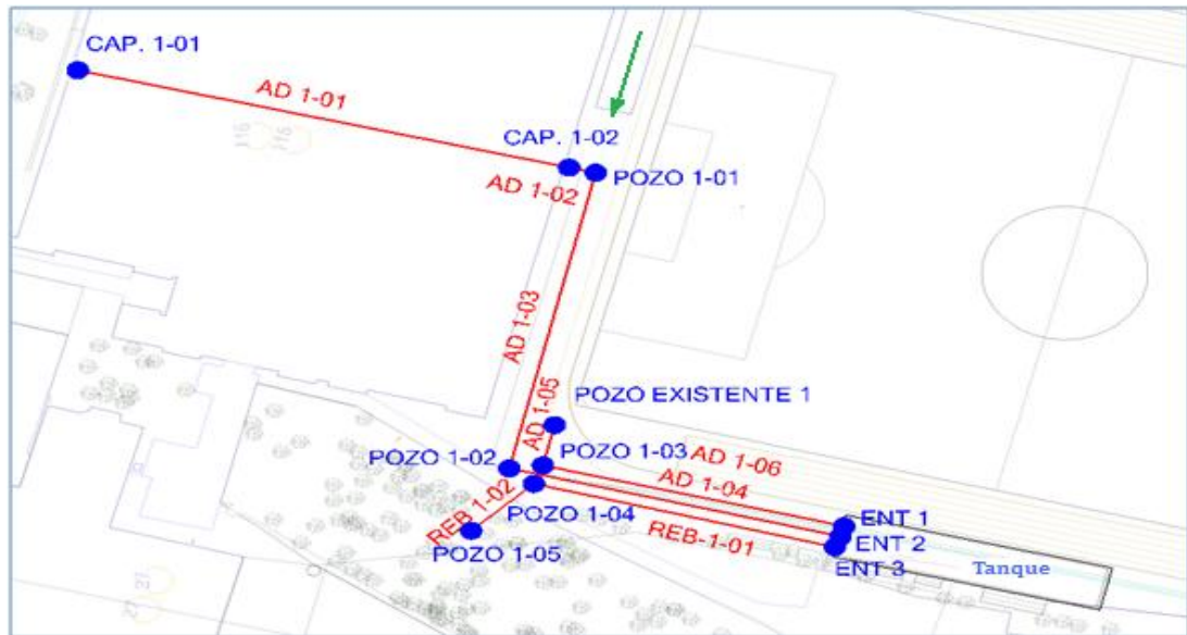
Figura 74. Red de aducción principal de la Subcuenca Campo de Fútbol, al instante de la unión de las aducciones 1 y 2. Red de control de excesos.
