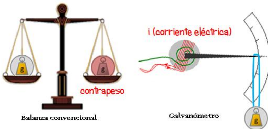
Figura 7: Comparación balanza convencional y galvanómetro con contrapeso [Autor]
