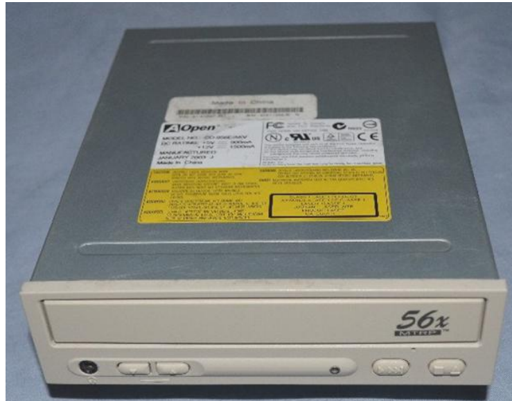
Figura 17: Lector CD computador de escritorio utilizado para el posicionamiento automático de la muestra
