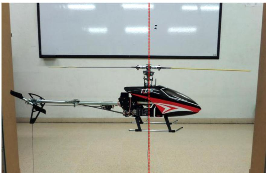
**Ilustración 3. Centro de masa sobre el eje  $z$ .**
