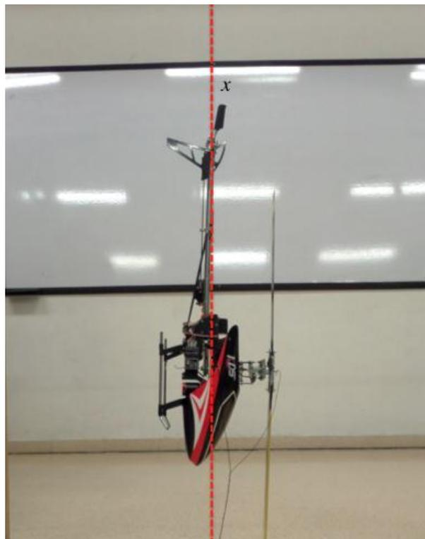
Ilustración 1. Centro de masa sobre el eje  $x$ .
