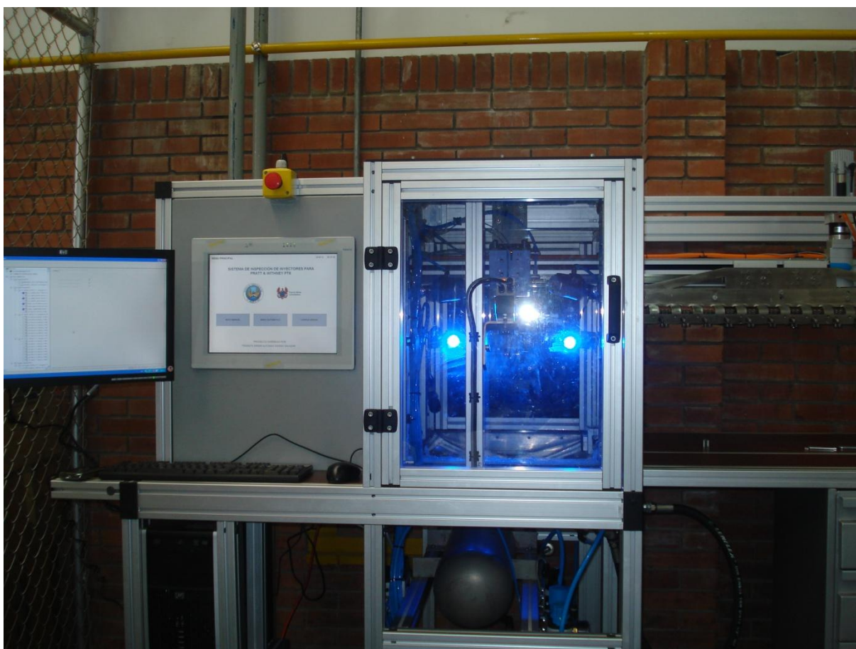
Figura 1. Sistema de inspección para inyectores Pratt & Whitney PT6
