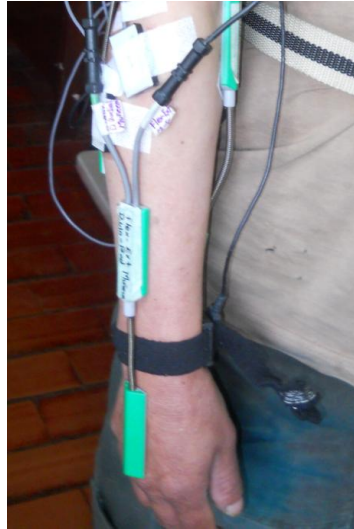
Figura 4. Ubicación del electro-goniómetro en los segmentos anatómicos
