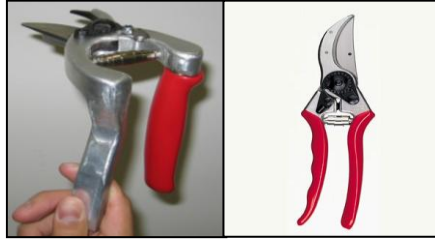
Figura 6. Herramienta prototipo con factores ergonómicos (Izquierda). Herramienta tradicional - Felco-2® (Derecha).
