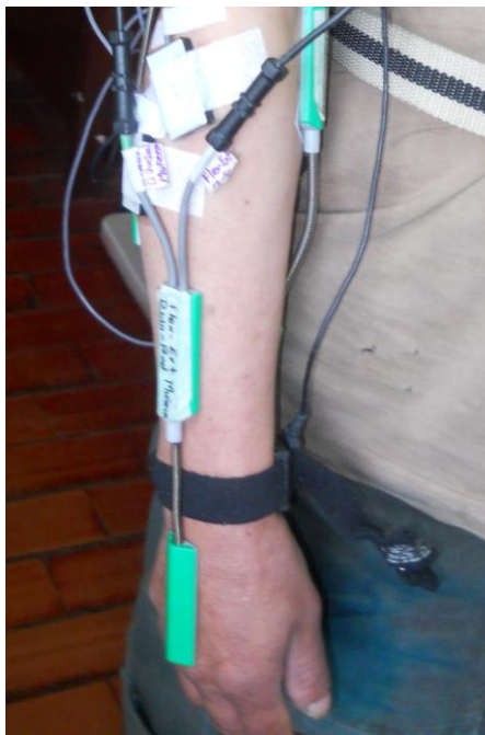
Figura 2. Ubicación del electro-goniómetro en los segmentos anatómicos
