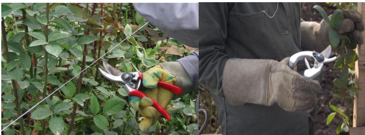
Figura 3. Uso de la herramienta tradicional - Felco-2® (Izquierda). uso de herramienta prototipo ergonómica (Derecha).
