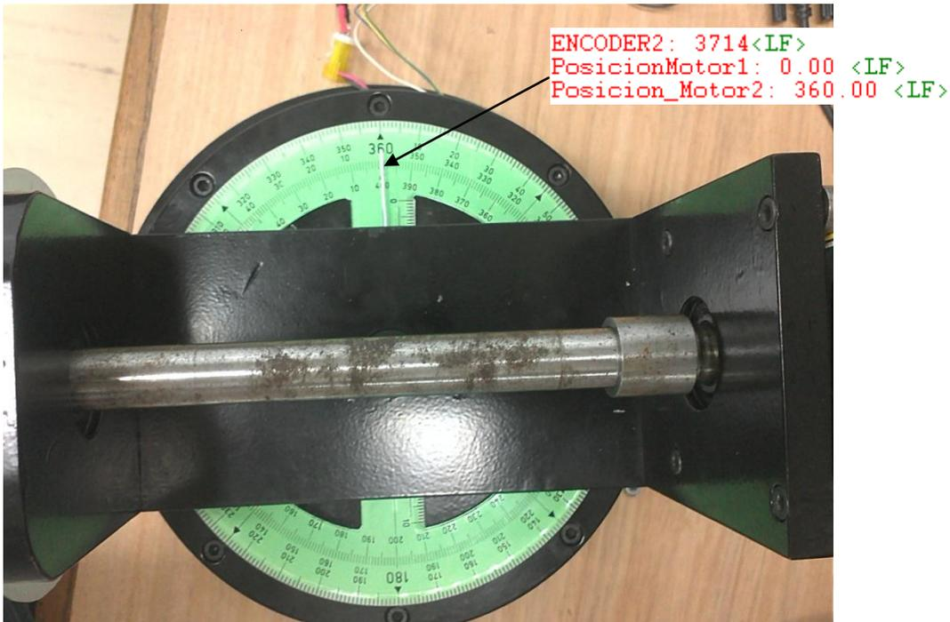
**FIGURA 5-17.** Numero de pulsos por vuelta Encoder 2, fuente el autor.
