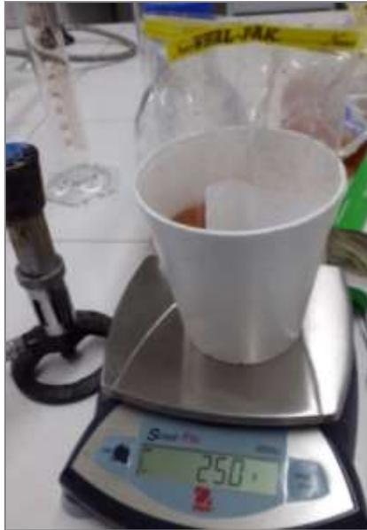
**Figura 4.** Pesaje de la muestra cárnica (25g).
