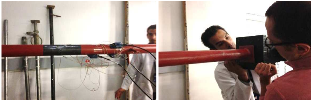
Figura 21. Montaje para el ensayo de un puntal
