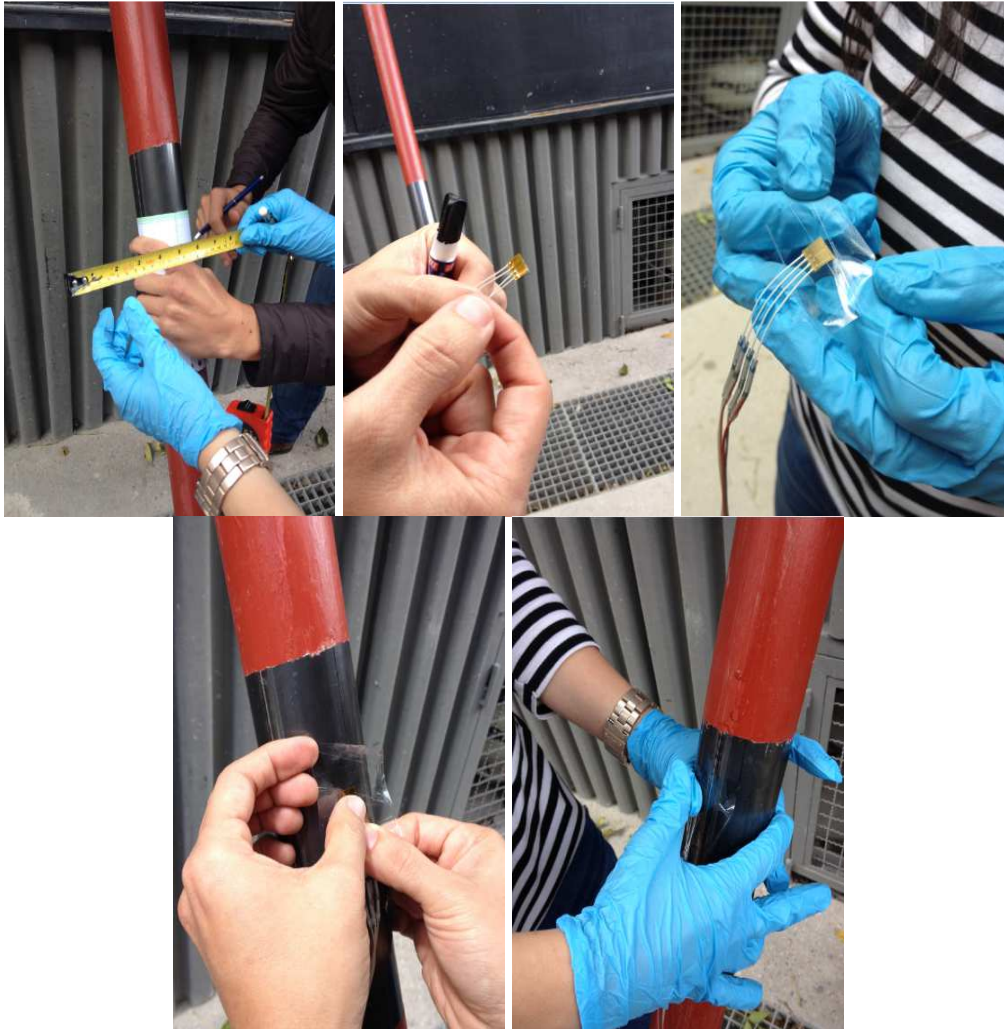
Figura 19. Procedimiento pegado de bandas extensométricas
