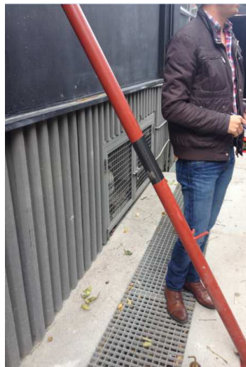
Figura 18. Superficie del puntal debidamente pulida
