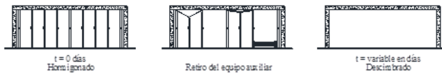
Figura 31. Operaciones realizadas para el descimbrado
