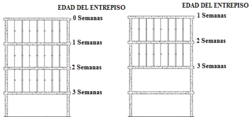
Figura 8. Operación de cimbrado y descimbrado para n=3
