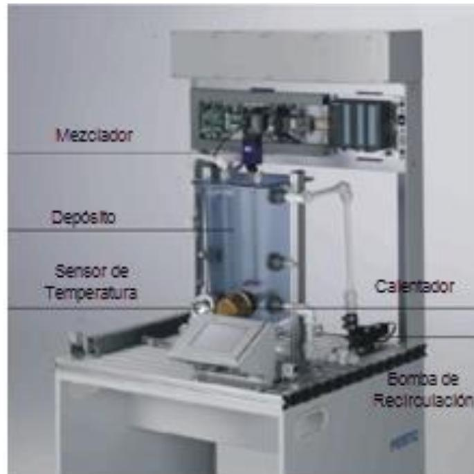
Figura 3.1 Estación del Reactor del MPS-PA de FESTO ®[11]
