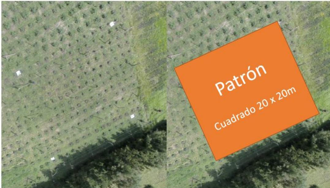
**Ilustración 34 Despliegue del patrón de 20 x 20m**
