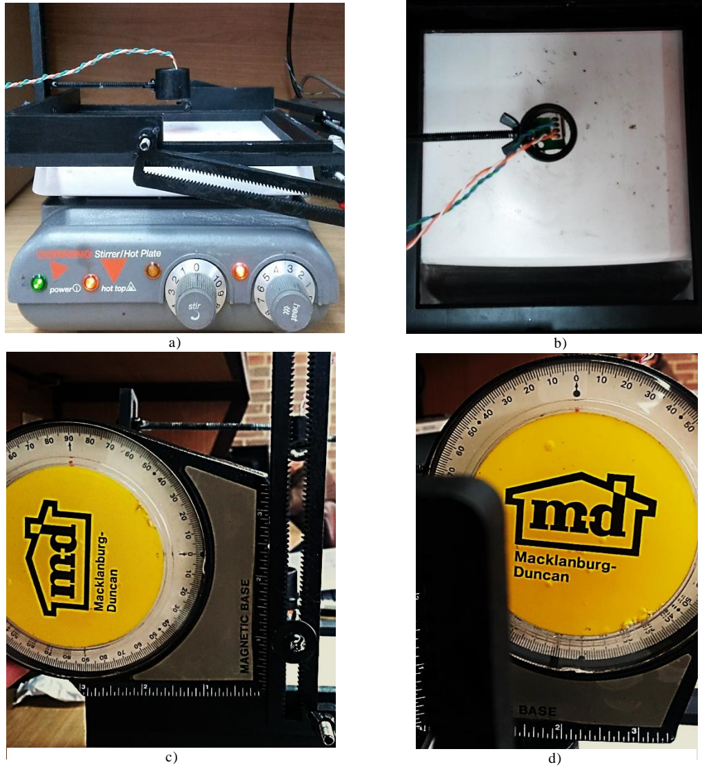
Figura 17. Ajuste del sensor de temperatura en el porta-muestras. a) Vista lateral del porta-muestras. b) Vista superior del porta-muestras. c) Ángulo de inclinación del soporte del sensor de temperatura. d) Ángulo de rotación del sensor de temperatura con respecto al plano que forma la muestra.
