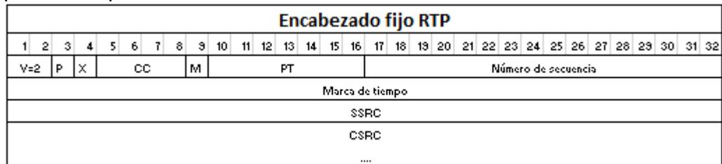
Figura 8. Encabezado fijo protocolo RTP.
