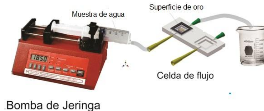
Fig 4.9 Montaje experimental para evaluar los efectos de exposición de la superficie sensora a muestras de agua tomadas In situ.
