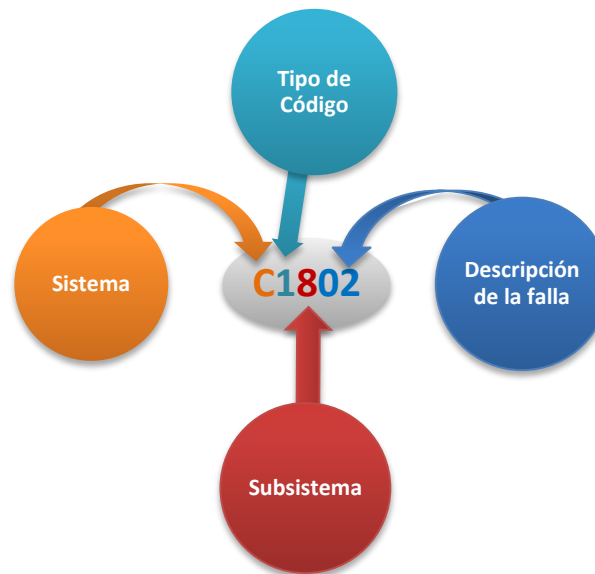
Figura 3: Función de cada carácter de un código de falla
