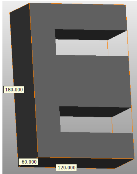
Figura 4.3.4.1.2-2 Esquema núcleo laminado dimensionado.
