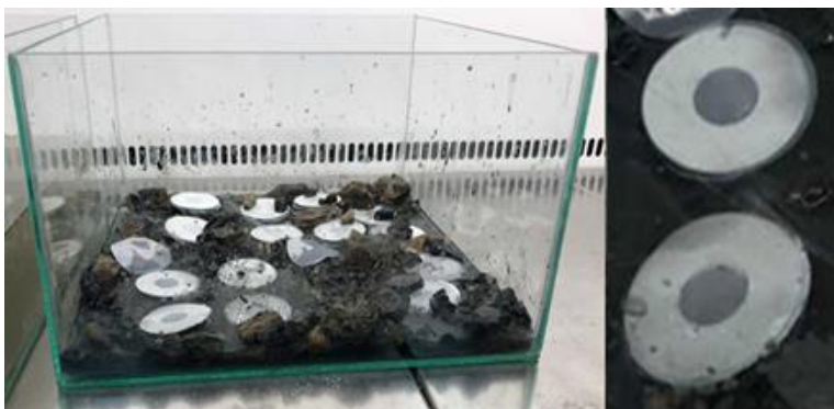
Figura 5. Montaje de cámaras de difusión en sedimentos del manantial P3
