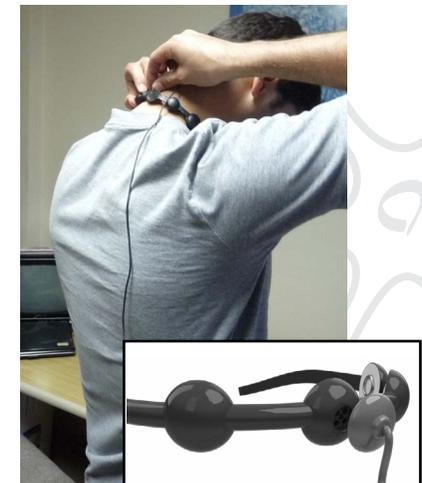
7. Llevar el otro extremo del cable hacia la parte posterior del collar y conectarlo al círculo central de este.
