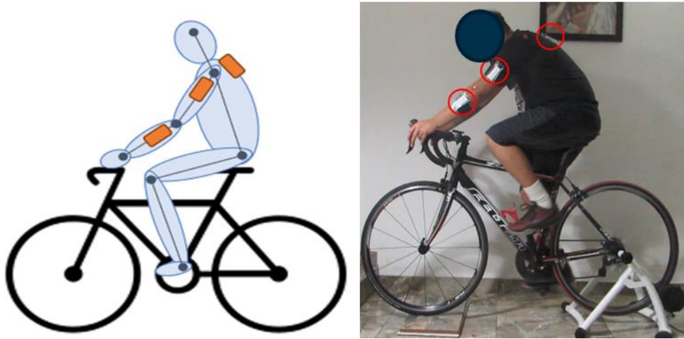
Figura 9. Demostración de la implementación de las IMU PocketLab One
