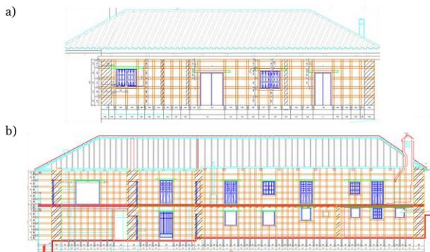
Figura 16. Esquema de reforzamiento cada 500 mm a) Casa de un piso, b) Casa de dos pisos
