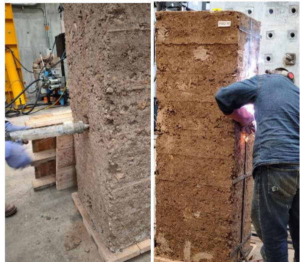
Figura 22 - Inyección de mortero en perforaciones y soldadura de conexiones entre pernos y platinas.
