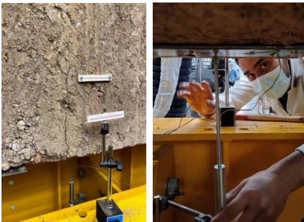
Figura 24 - Sensores de desplazamiento laser y LVDT
