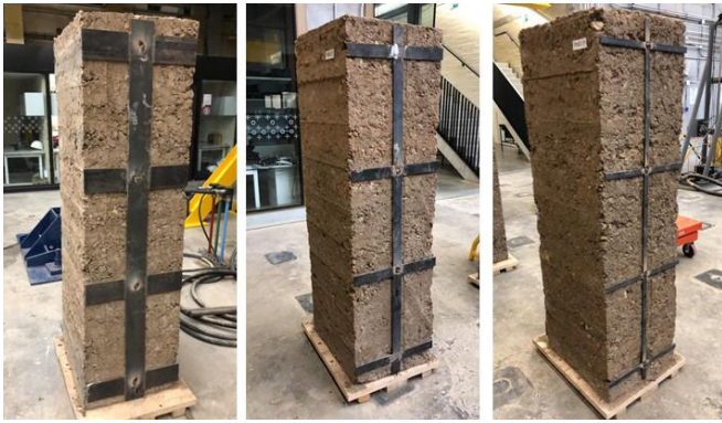
Figura 23 - Tipos de reforzamiento en muros de tapia pisada en función de la cuantía de acero requerida
