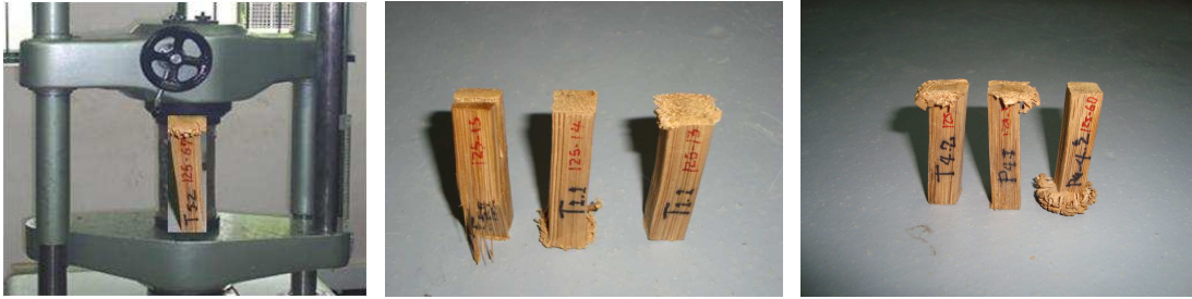
Figura 2. Prueba de resistencia a la compresión en probetas de G. angustifolia .
