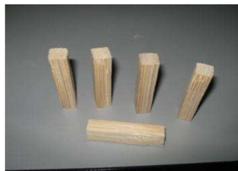
Figura 1. Dimensiones de las probetas empleadas en los ensayos de resistencia natural.
