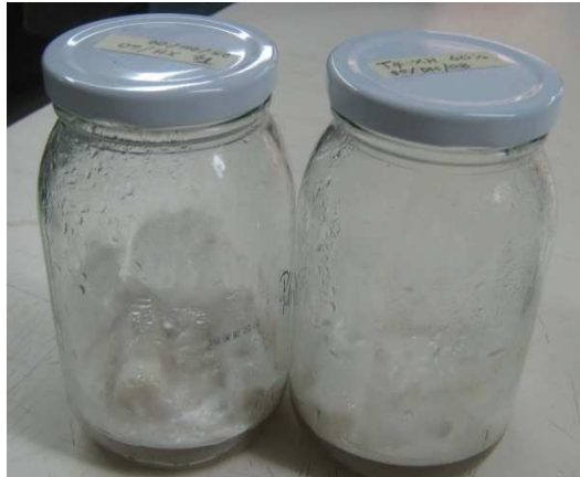
Figura 3. Colonización de Xylaria hypoxylon sobre probetas de G. angustifolia
