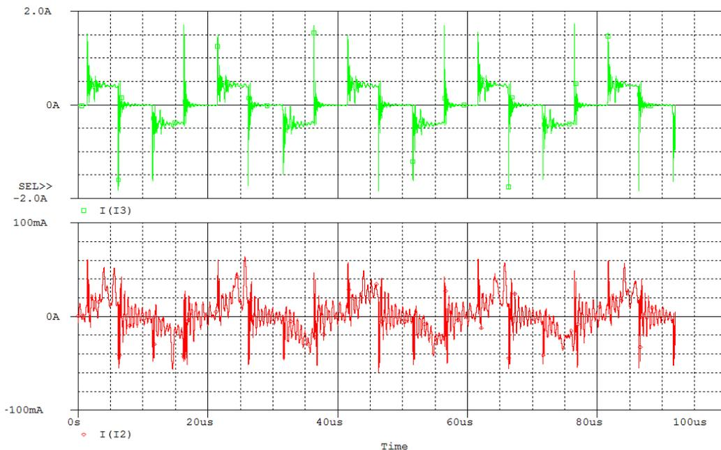
**Ilustración 69: Corriente sobre el primario y secundario del transformador E80**
