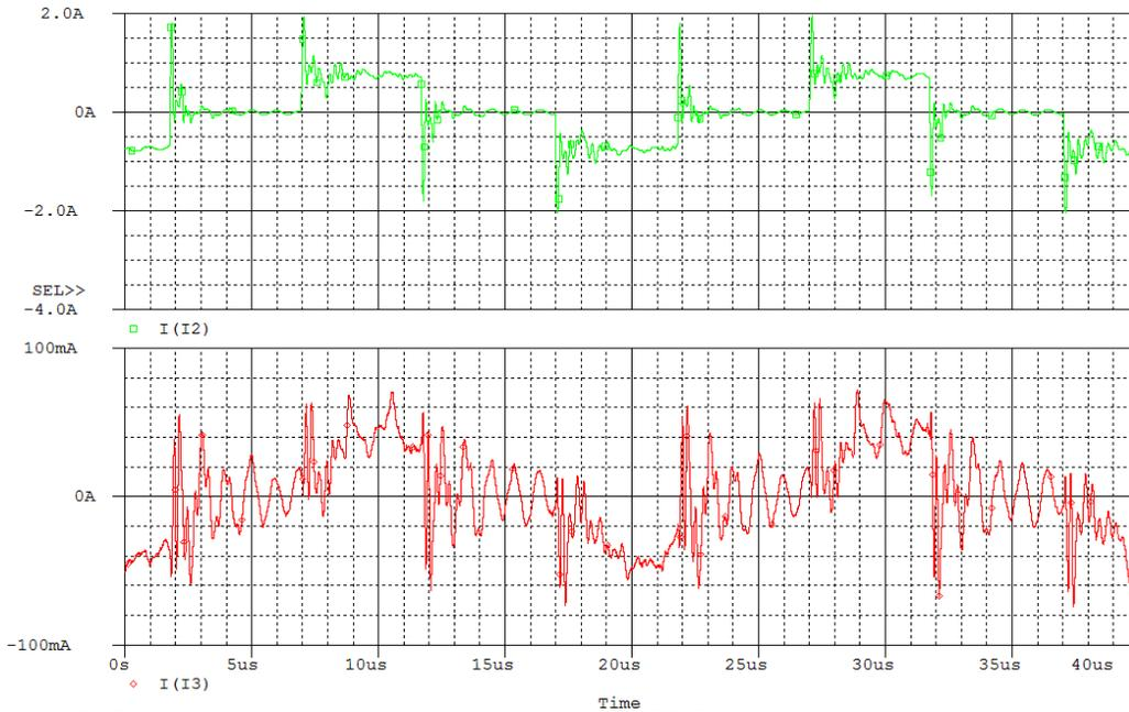
Ilustración 60: Gráfica de corriente en primario y secundario del transformador U93 Bobinado con una sola pata conectado a la lámpara DBD.
