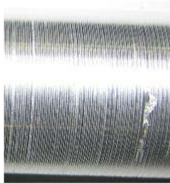
Imagen 2. Aluminio con deformación superficial.
